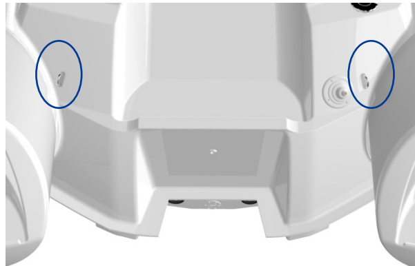
Bild 27. Lyftöglor, som är placerade på båtens akter, 2 st.
