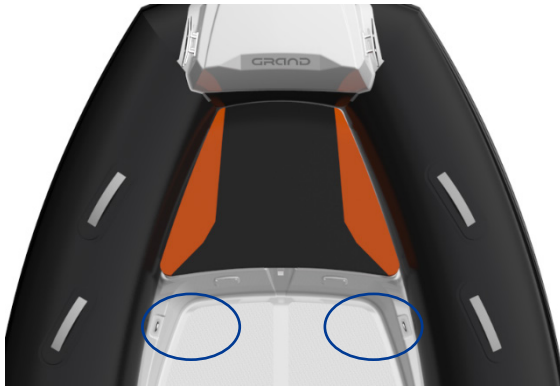
Bild 26. Lyftöglor, som är placerade på båtens bog, 2 st.
